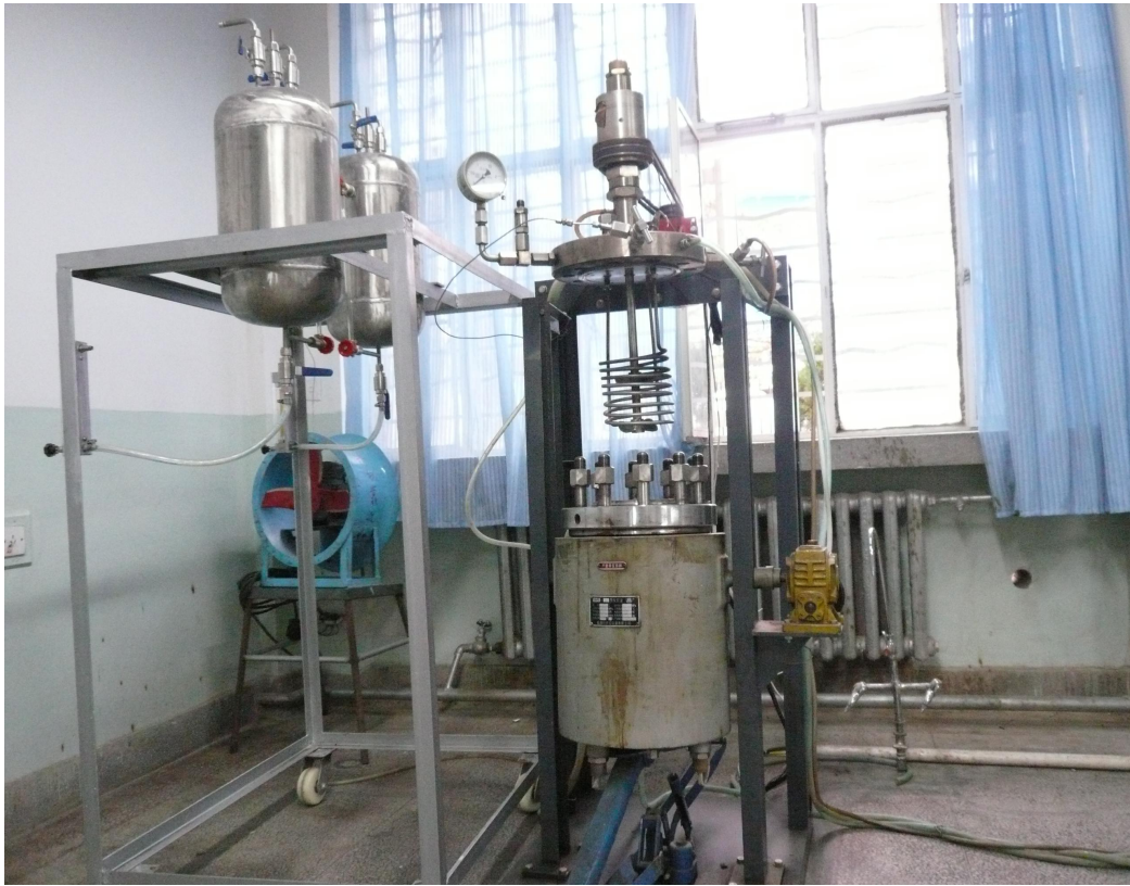
高压釜式反应装置
